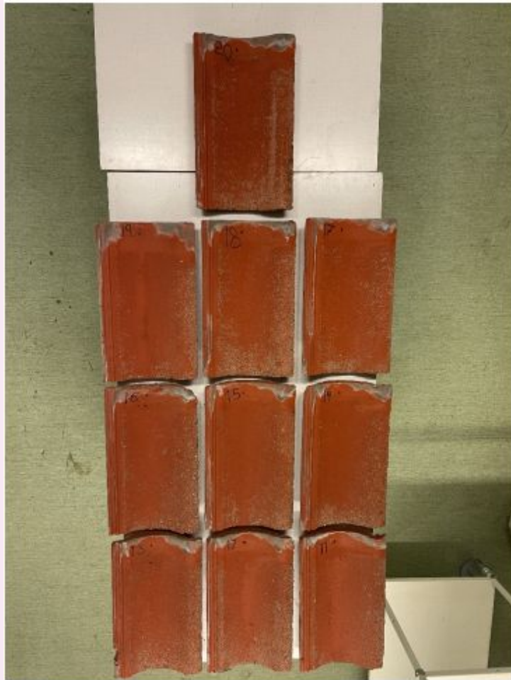
Foto 4: Bildet viser betongtakstein etter fryse og tine prøving
