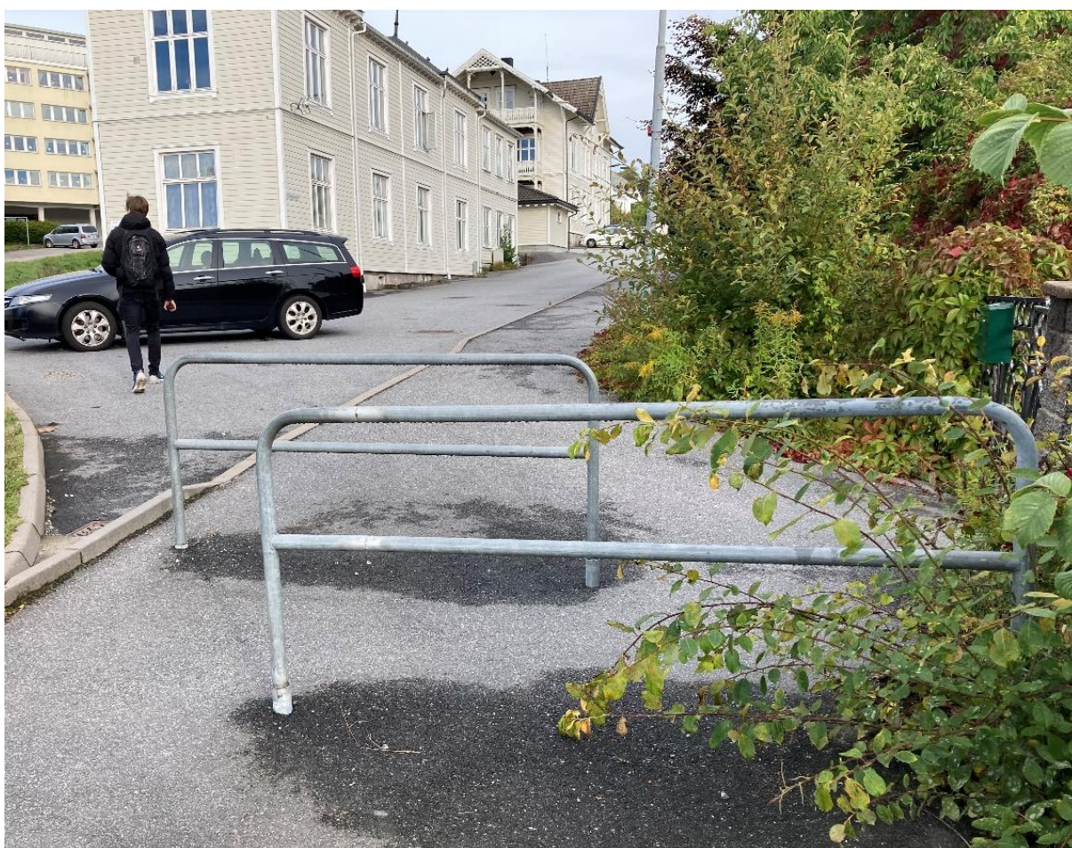
Figur 4-20. Eksempel på hindring på fortau som gir svært dårlig fremkommelighet for gående, syklende og trilling av barnevogn. Foto: Asplan Viak.
